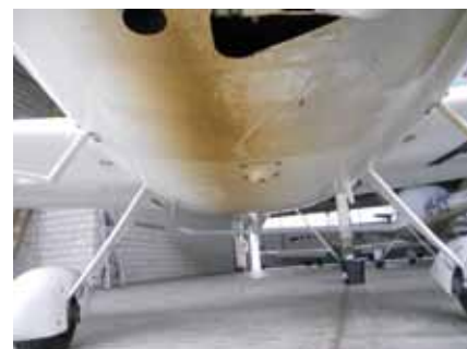
Starke Schmutz- und Russablagerungen können sich in den Lack einfressen.
