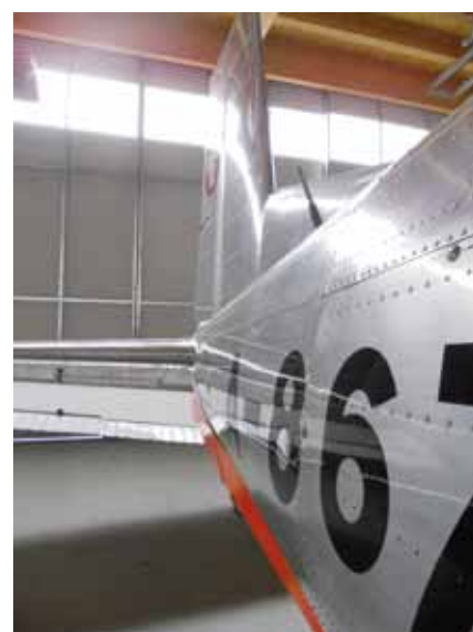
Die behandelten Aluflächen sind hydrophob und können nicht mehr oxydieren.
